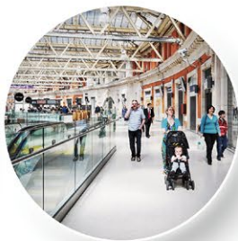
Zábradlí z bezpečnostního lepeného skla
